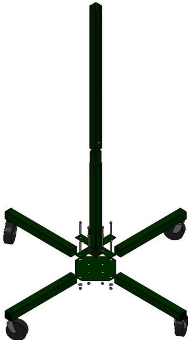
1 – Abulonar las patas (1), la placa base (2) y el parante inferior (3) entre sí. Utilizar 2 bulones de 5/16x3" con 2 tuercas de 5/16", 2 arandelas planas de 5/16" y 2 arandelas grower de 5/16" por pata.
